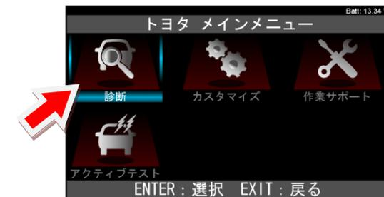
7. システム選択画面が表示されます。目的に合った項目を選択して[ENTER]ボタンを押します。(例：全自己診断の場合)
