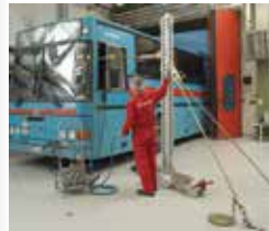
CT3200AL プリングタワー アンカーボット用 H3,430mm (移動時H3,470mm)
