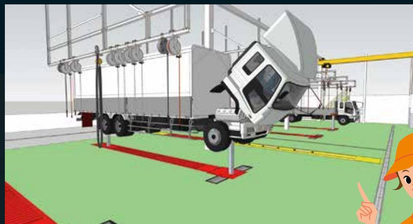
大型車のキャビンをチルトしても前方に十分なスペースを確保
