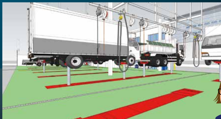
マルチに使用可能な 4 柱キャタピラリフト 前後で 2 台の車両のリフトアップや大型車のリフトアップが可能ですのでストールの有効活用が可能です。
