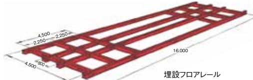
埋設フロアレール
