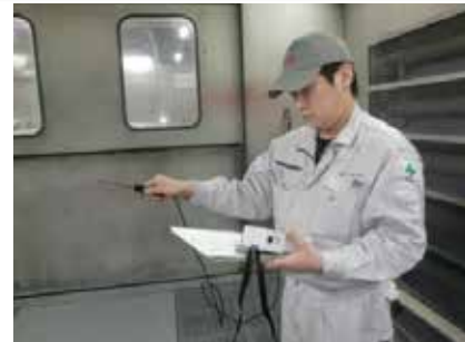
制御風速測定
