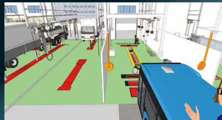
効率的なレイアウト 効率的な機器の配置によりスムーズな作業、検査が行えます。
