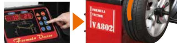
■ タイヤとホイールのアンバランス測定終了後、ウェイト貼り付け位置まで自動で回転、停止するシステムです。
