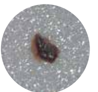
▲鉄粉が刺さっている部分の拡大写真
