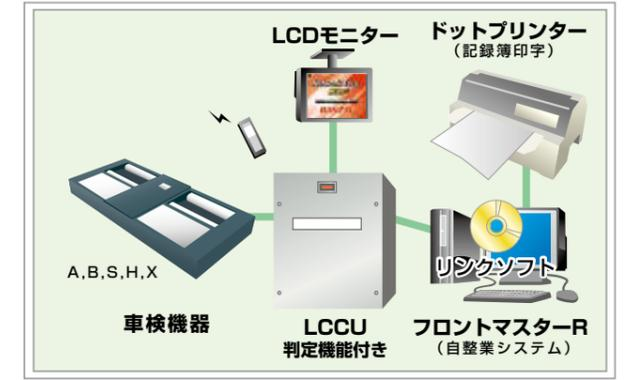
フロントマスターR(自整業システム)と検査ライン(ネットワークEasy Plus)を連動し、記録簿の検査項目欄の印字を可能にしたシステム。
