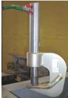
フランジ面局部曲がり修正 (10t)
