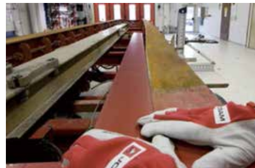
直定規による曲がり確認
