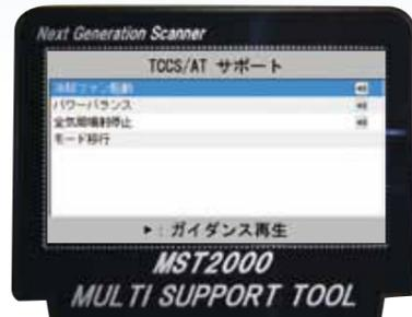
各コンピュータに診断機から信号を送り、特定の部品を作動・停止させます。
