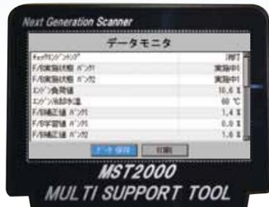
センサーからECUに送られている信号を表示します。エンジンやHV、ABS、ボディ系に対応しています。またデータ項目を個別に選択して絞り込む事が可能です。
