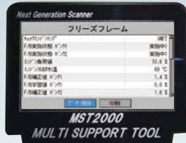
故障コードが入った瞬間のデータモニタを表示します。
