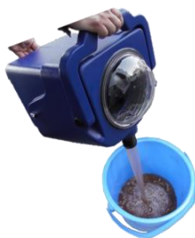
③シートを洗浄します 素早く2～3回程度 往復させます。
