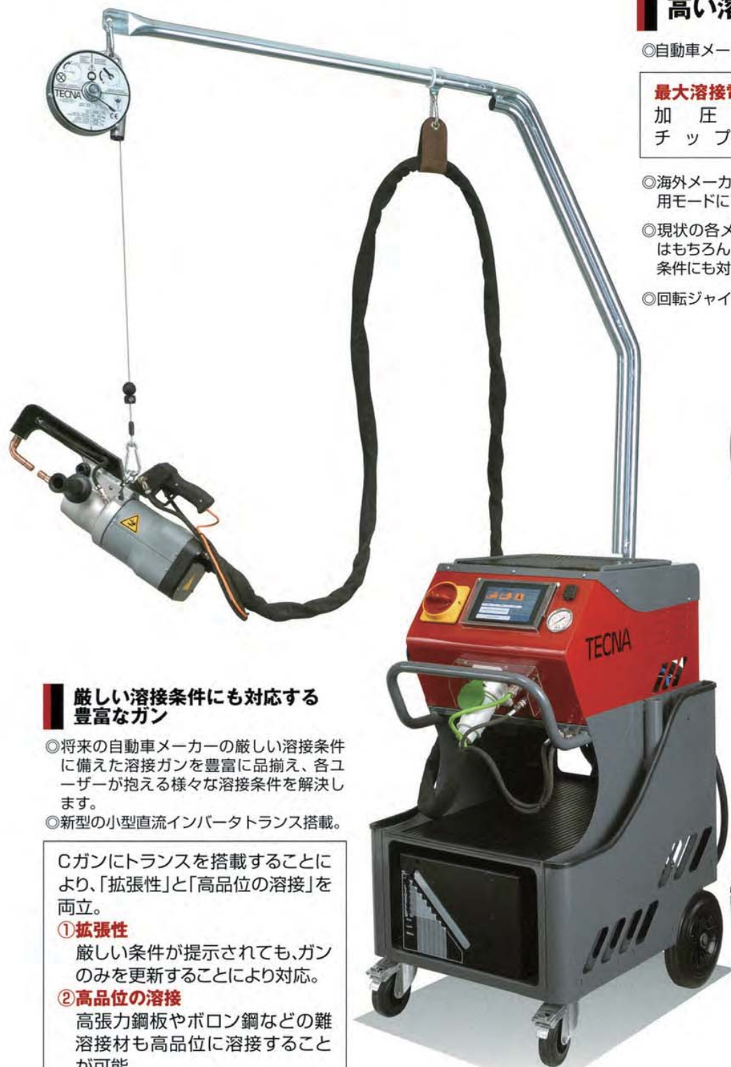
高張力鋼板、780MPa 板厚1mm 2~4枚
